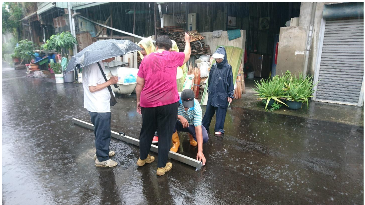
上二圖 抽查驗工區九樂成里育英路 23 巷（東英二街至育英路）路面改善工程道路平整度
