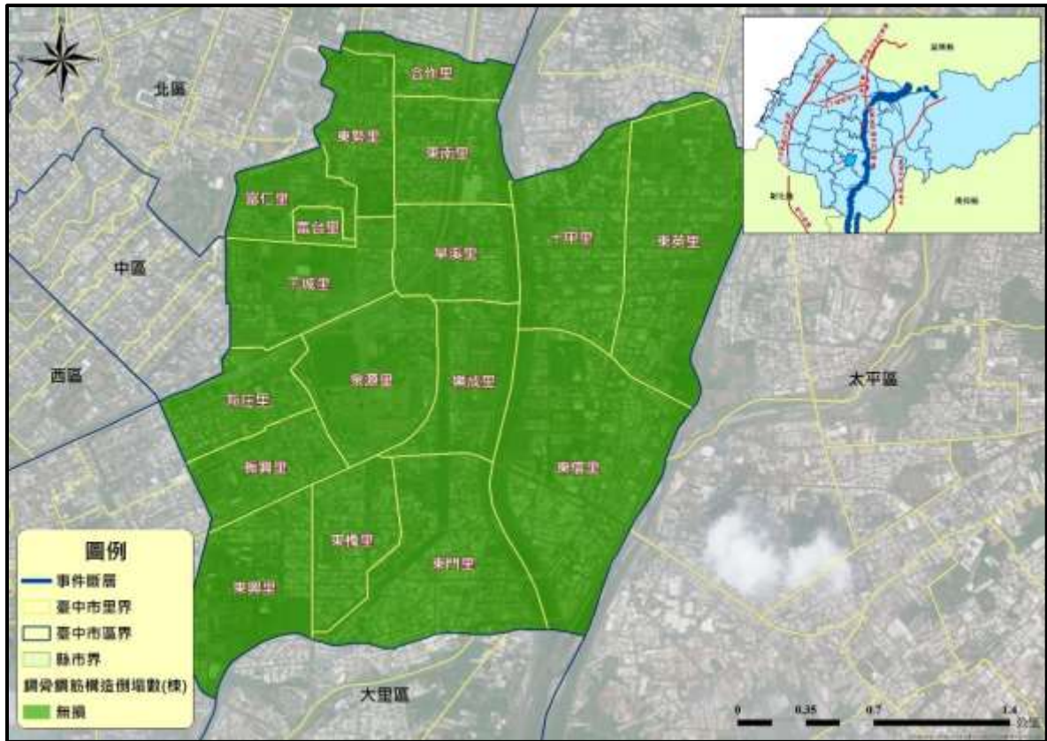
圖 1-3-20 東區震災模擬事件各里鋼骨鋼筋混凝土構造全倒棟數推估
